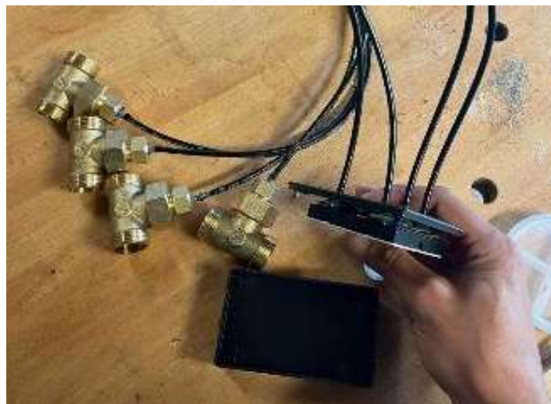
Figure 60 : Photo des capteurs connectés aux raccords hydrauliques en laiton
