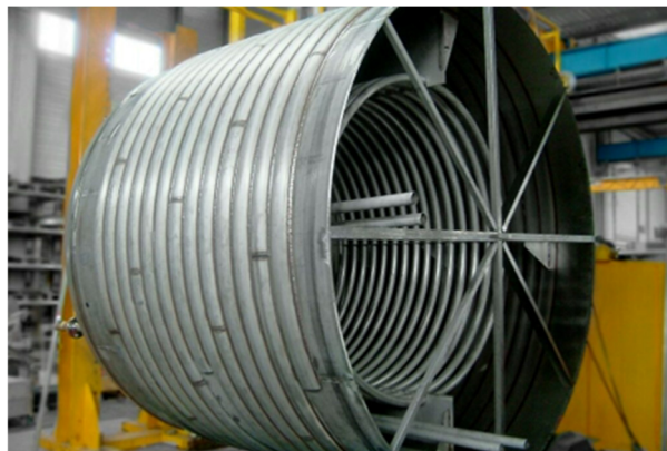
Figure 2 Exemple d'échangeur de chaleur à serpentin
