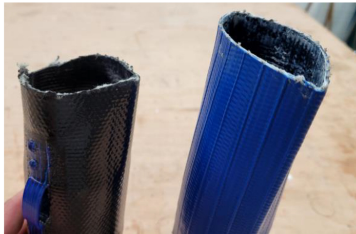
Photo 4-1: Tuyau A se rétractant sous pression (côté gauche) et tuyau B s'allongeant sous pression (côté droit).
